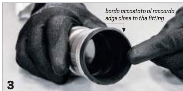
3 Verificare posizionamento guarnizione / Verify the correct gasket's position
