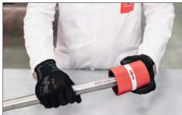
Sbavatura del tubo / Deburring the pipe
