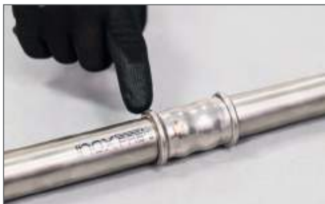
Controllo della pressatura / Checking the press connection
